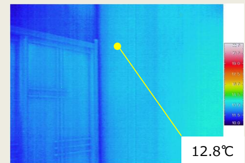
▲ガイナ未施工部屋内壁
